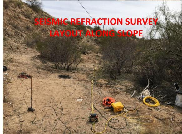
**SEISMIC REFRACTION SURVEY
